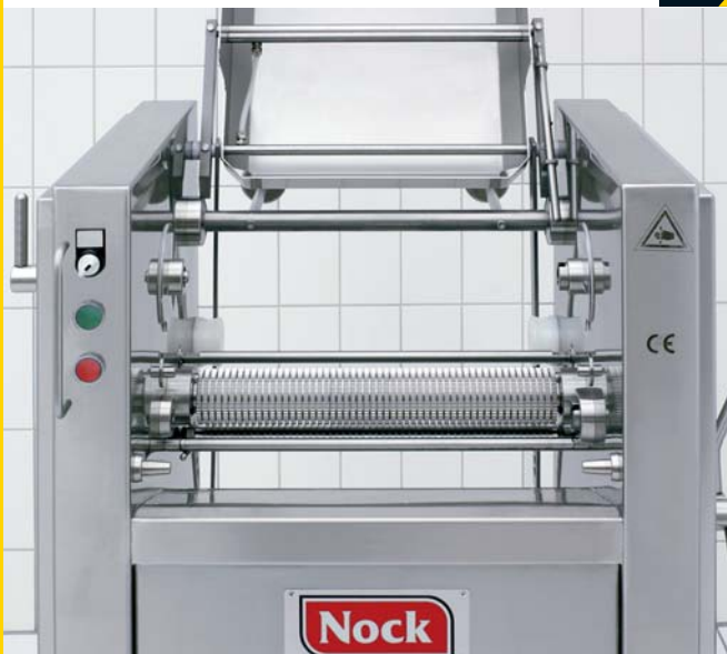
Schnell und einfach zu reinigen: Automatische NOCK Fisch-Enthäutungsmaschine nach Herausnahme von Transportbändern, Andruckwalze und Messerhalter
