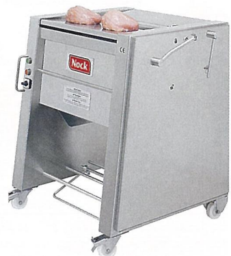
Die Hochleistungs-Entvliesmaschine Vliesex V 5744 Turbo hat eine Schnittbreite von 500 mm und ein trapezförmiges Gehäuse, welches hohe Kippsicherheit verleiht.
