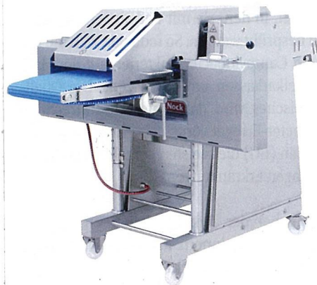
Die Rundmesser Schneidemaschine Nock Cortex CB Slicer ermöglicht das schonende Schneiden von Geflügebrust.
